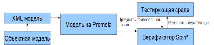
Рис 4. Схема перевода моделей при статической верификации
